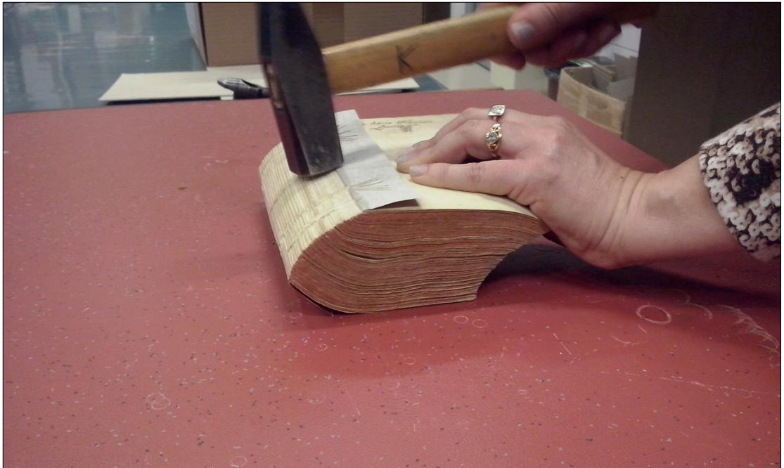
Slika 43. Ručno zaobljavanje hrpta knjižnog bloka
