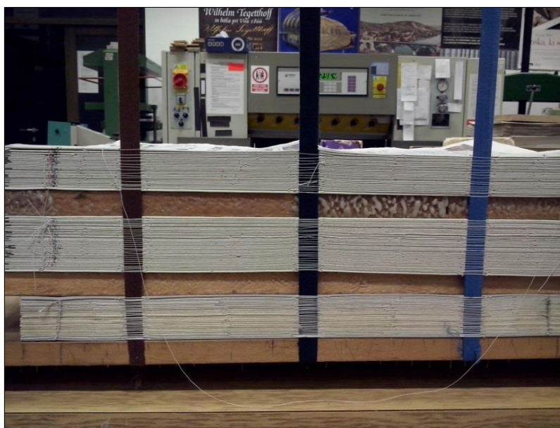
Slika 19. Ručno povezivanje knjižnih slogova uz pomoć platnenih traka; prešivanje platnenih vezica
