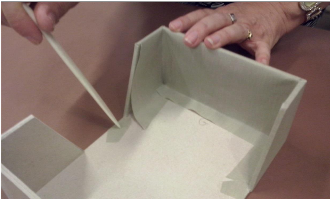
Slika 53. Presvlačenje donje kolijevke presvlakom od arhivskog platna
