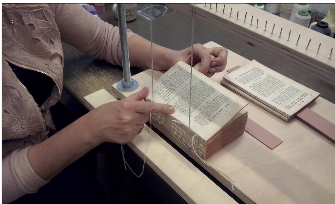
Slika 40. Šivanje na šivaljki, na dvije upiljene vezice
