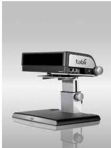
Slika 14. Uređaj Tobii X60 Eye Tracker
