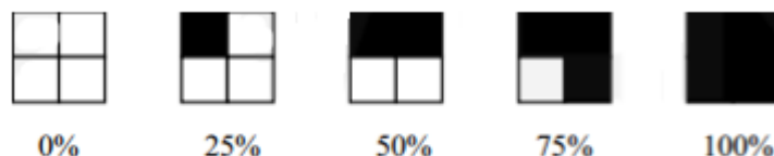
Slika 12. Pojednostavljena shema rasterskog elementa ( Preuzeto iz članka: A Critical Review of Spectral Models Applied to Binary Color Printing, Wyble, David R. )
