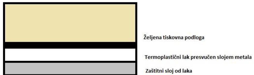
Slika 19. Prijenos na željenu tiskovnu podlogu [16]
