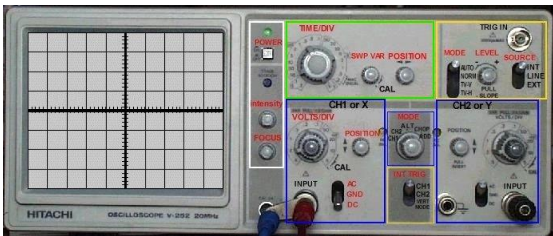
Slika 16 - Mjerni instrument osciloskop
