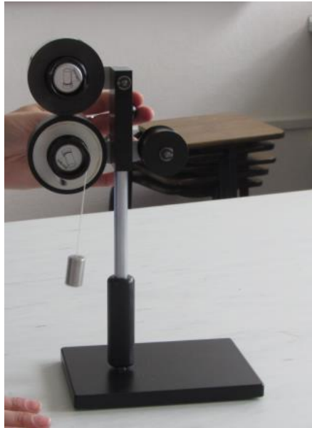
Slika 14. IGT uređaj za određivanje stupnja prašenja premaza (prijenos tiskarske boje na tiskovnu formu)
