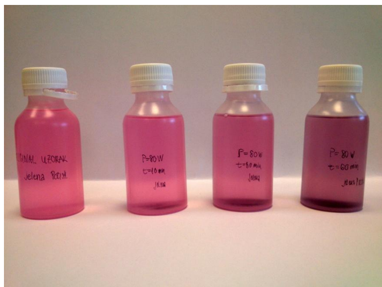
Slika 10. Usporedba originala i ultrazvučno ozračivanih uzoraka snagom ultrazvuka od 80 W pri različitim vremenima trajanja ozračivanja
