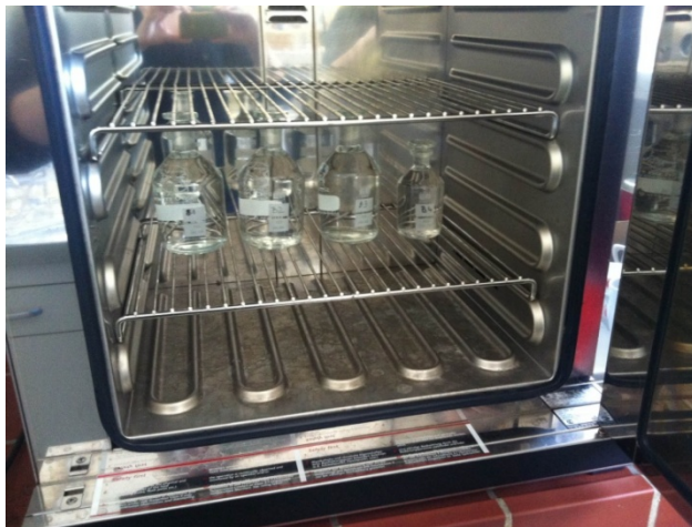
Slika 16: Termostat u kojem se odvija oksidacija
