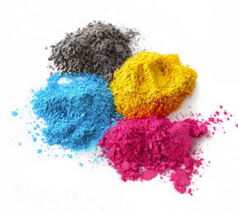
Slika 4: Prikaz netopivog finog praha pigmenata
