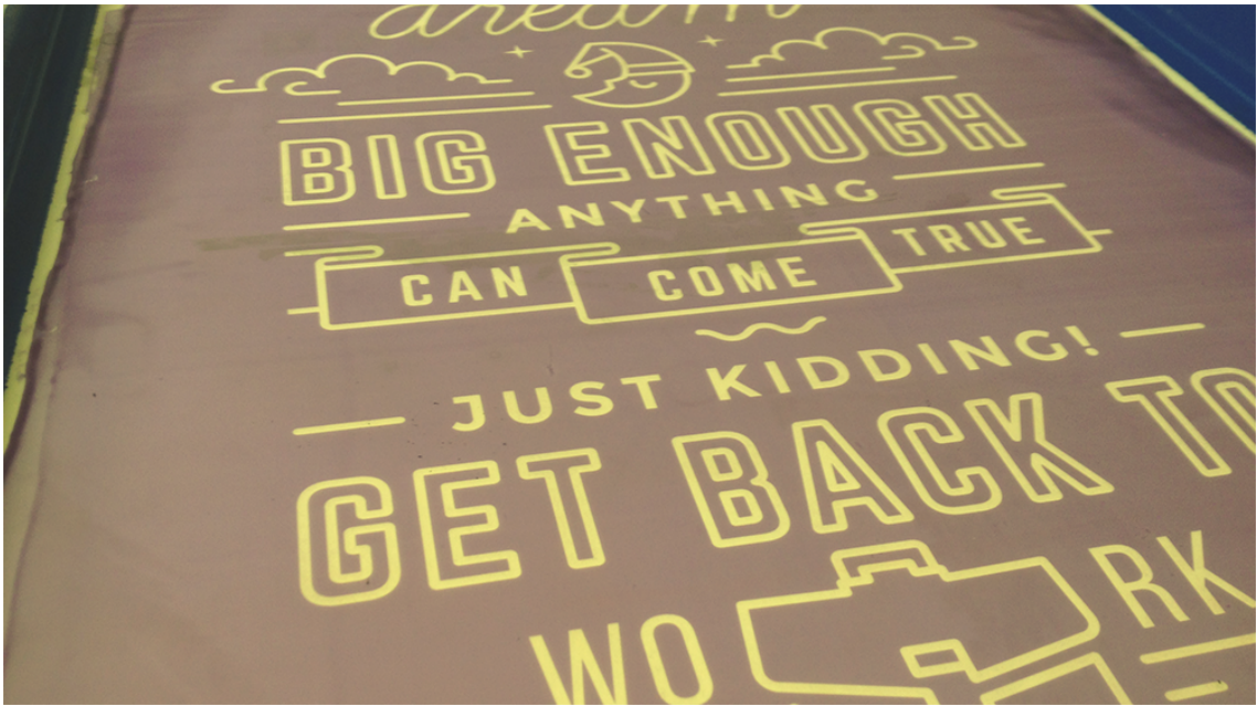
Slika 17. Tiskovna forma s mrežicom od 100lin/cm
