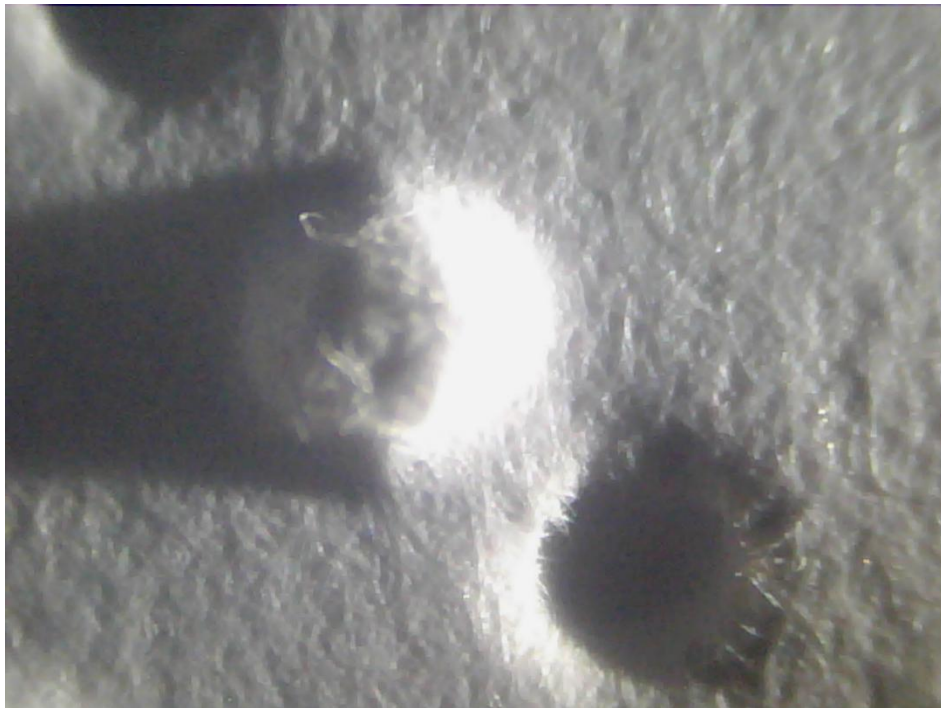
Slika 11. Povećani reljef brailleove točkice
