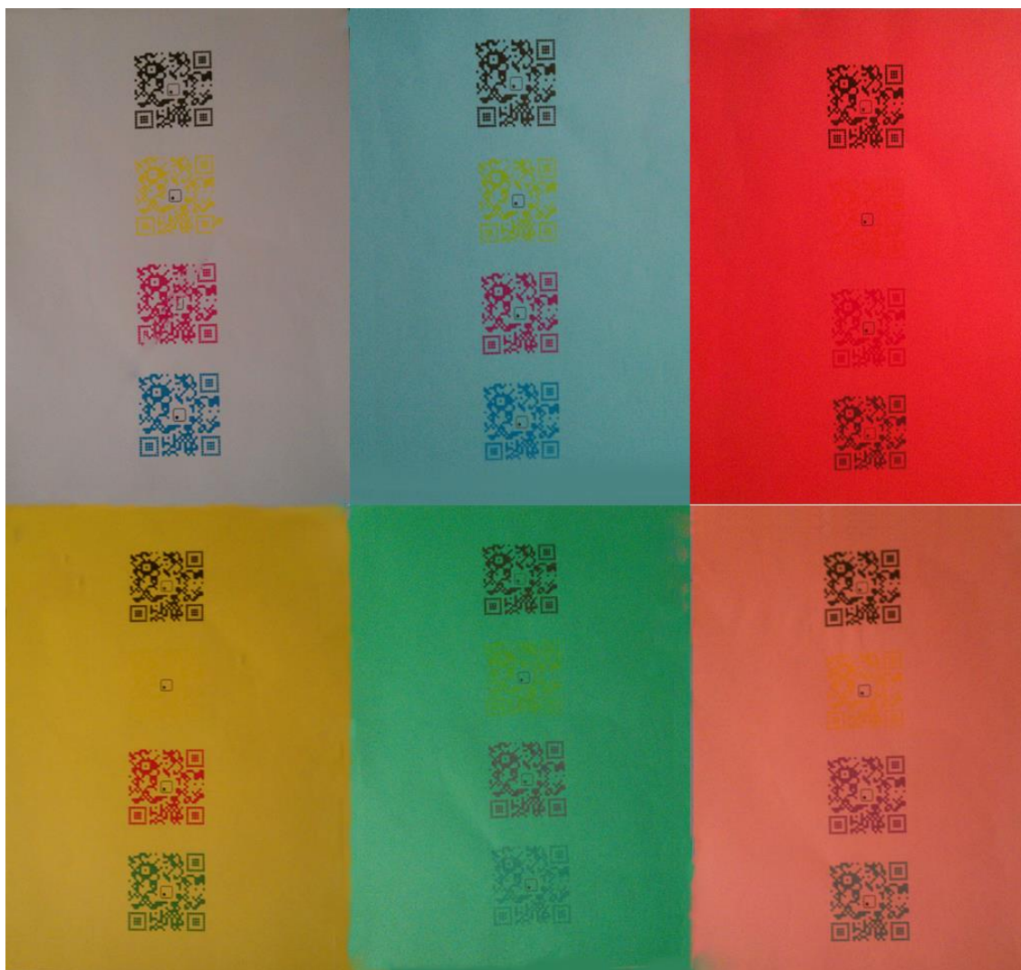
Slika 19. – Ispisani QR kodovi na različitim podlogama Konica Minolta C550 pisačem
