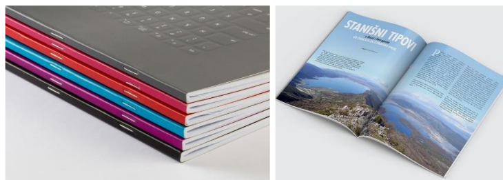
Slika 20. Primjeri šivane forme uveza žicom kroz hrbat
