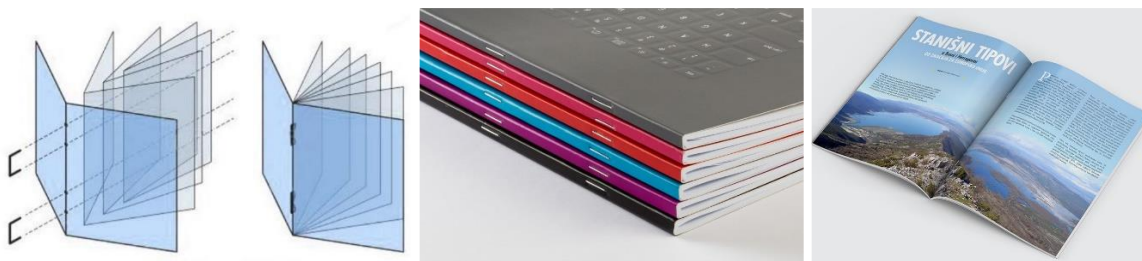
Slika 19. Šivanje žicom kroz hrbat
