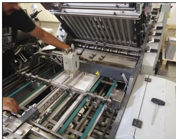
Slika 60. Postavljanje savijačice na željenu veličinu arka za savijanje
