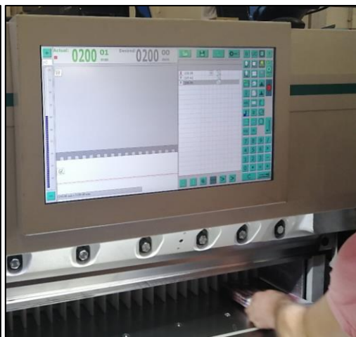
Slika 95. Postavke na brzorezaču
