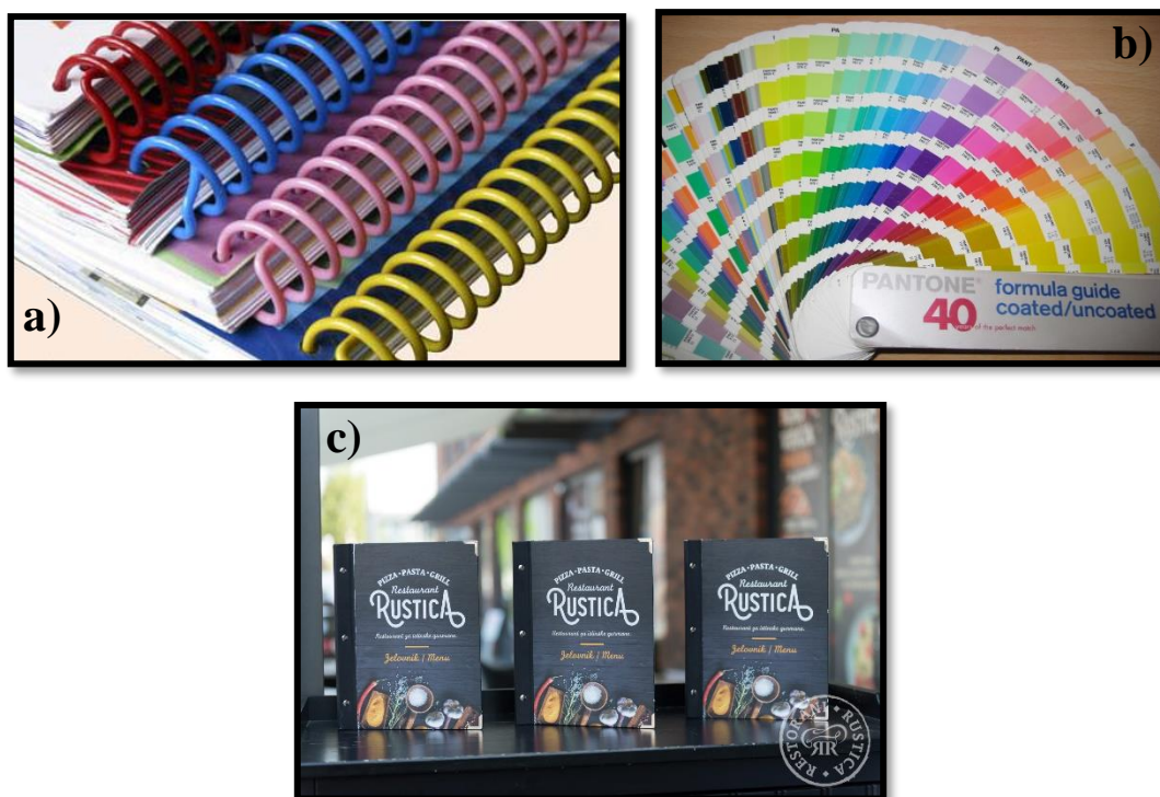
Slika 7. Mehanički uvez: a) spiralni, b) zakovica c) vijak i matica
