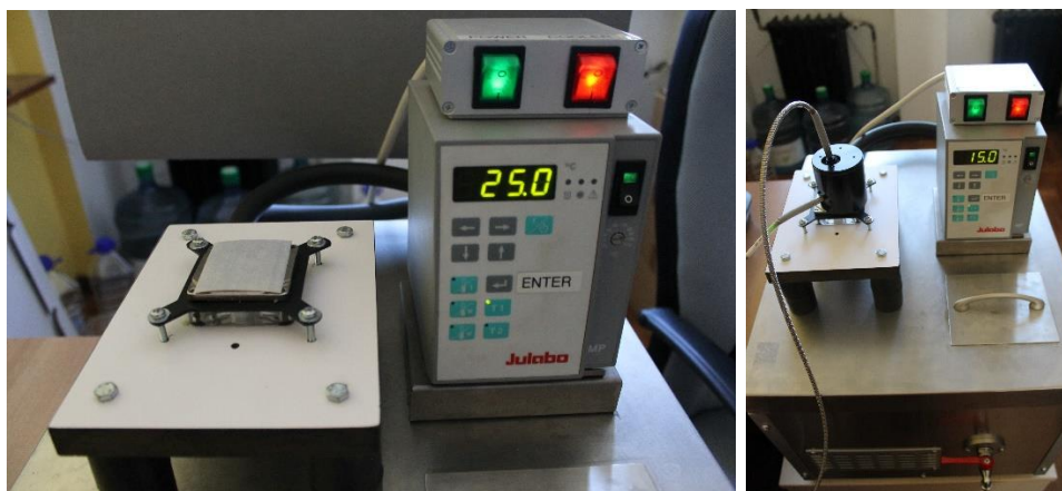
Slika 17 Elektrostatski cikulator s postavljenim uzorkom na pločici (lijevo) i spektrofotometrom prilikom mjerenja (desno)
