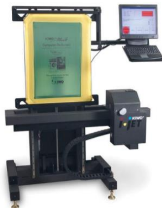
Slika 6. Izrada tiskovne forme za sitotisak CtP tehnologijom
