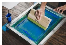
Slika 1. Proces otiskivanja u sitotisku
