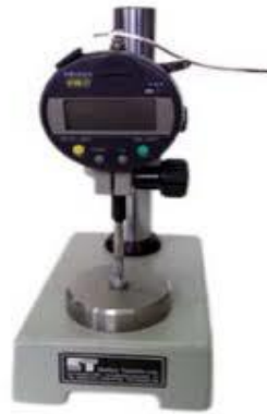
Slika 3. Elektronički ručni mikrometar za ispitivanje debljine papira, kartona i ljepenke
