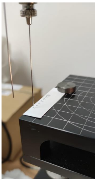
Slika 29. Prikaz postupka mjerenja kontaktnih kuteva
