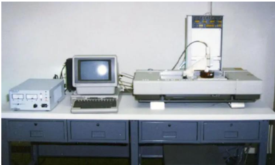
Slika 1. Prvi SLA 3D uređaj izumitelja Charles-a Hull-a
