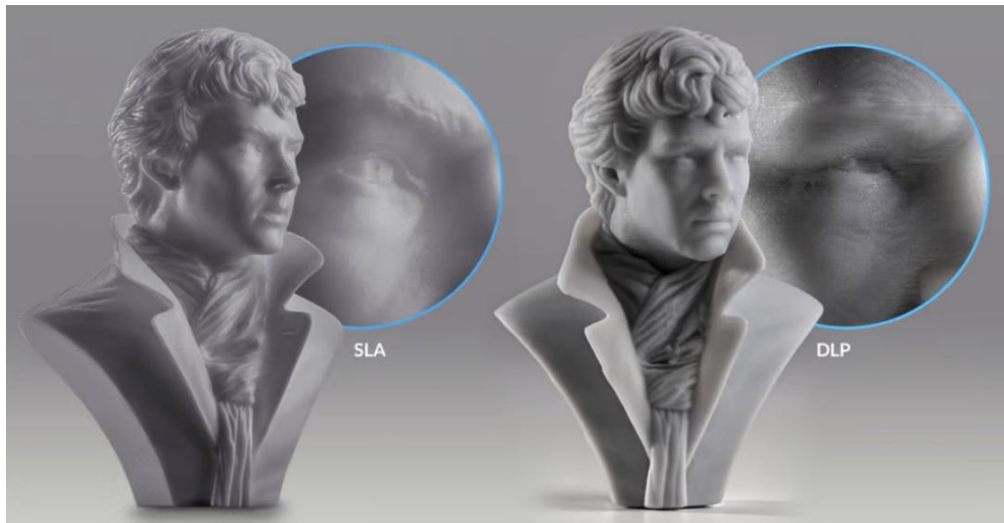
Slika 4. Usporedba ispisa SLA i DLP 3D tehnologijom
