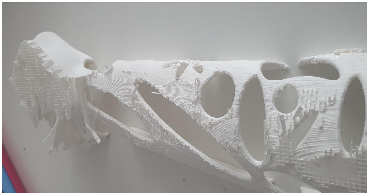
Slika 33. Način skidanja potpore
