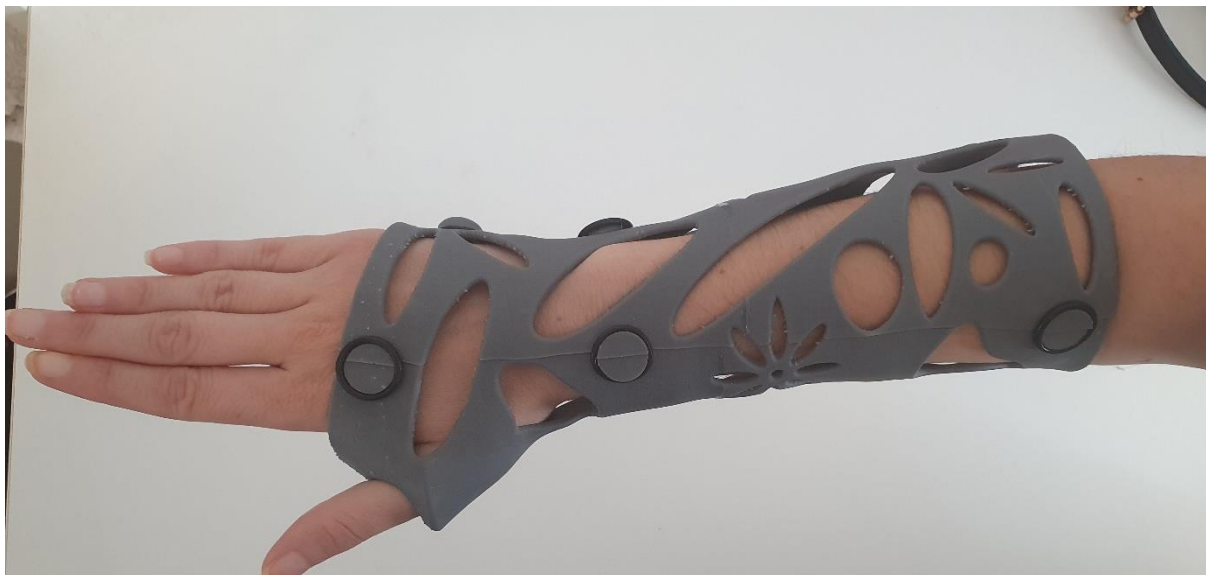
Slika 37. Longeta učvršćena O-ring gubicama - SLA materijal gornja strana ruke
