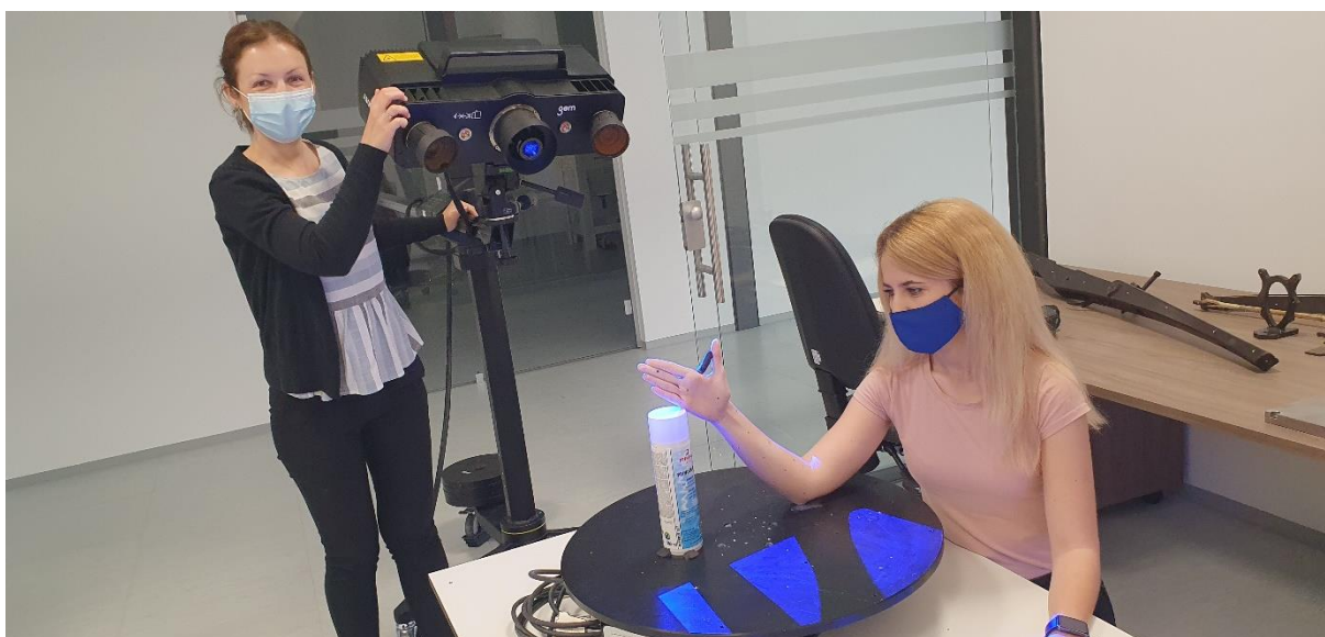
Slika 11. Skeniranje ruke pomoću 3D skenera
