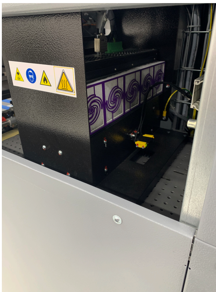
Slika 8 UV lampe u sustavu za osvjetljavanje
