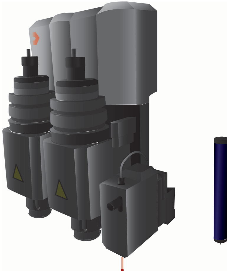
Slika 24. Premještaj lasera na poziciju pisljke
