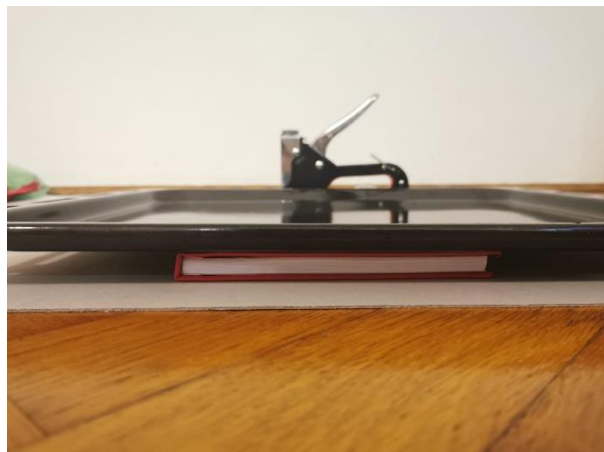
Slika 17. Spajanje knjižnog bloka i korica te prešanje
