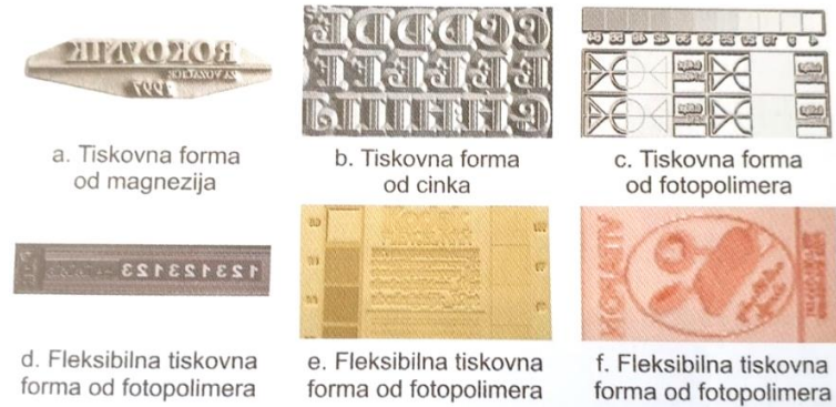
Slika 4.5 Različiti tipovi tiskovnih formi za visoki tisak[7]
