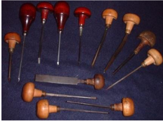
Slika 2.2 Alat za ručno graviranje[2]
