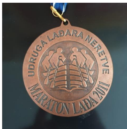
Slika 3.4 Obrada mehaničkim graviranjem
