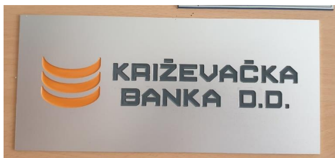
Slika 3.3 Obrada mehaničkim graviranjem s ispunom boje
