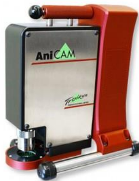
Slika 5.9 3D skenirajući mikroskop
