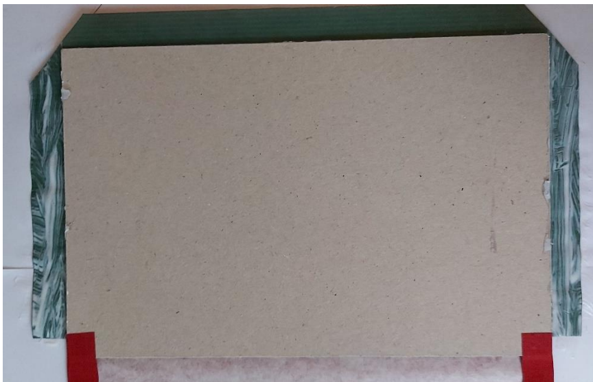
Slika 39. Uljepljivanje prireza na presvlaku
