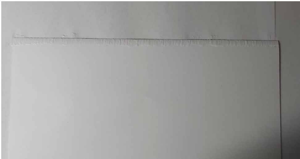
Slika 46. Podstava premazana ljepilom, spajanje s knjižnim blokom
