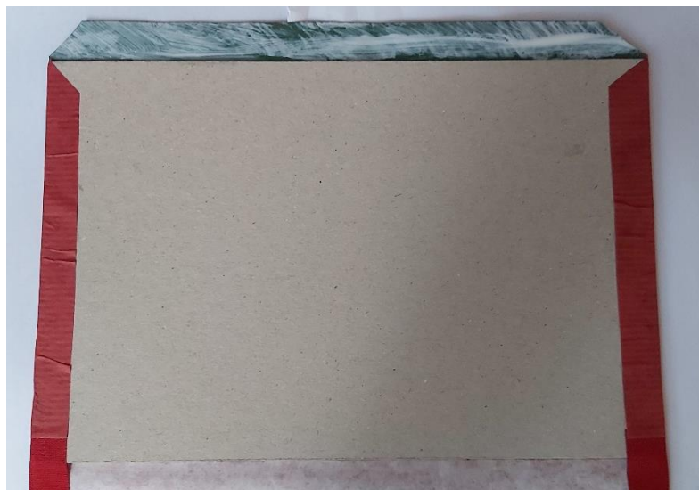
Slika 40. Zarubljivanje presvlake preko prireza
