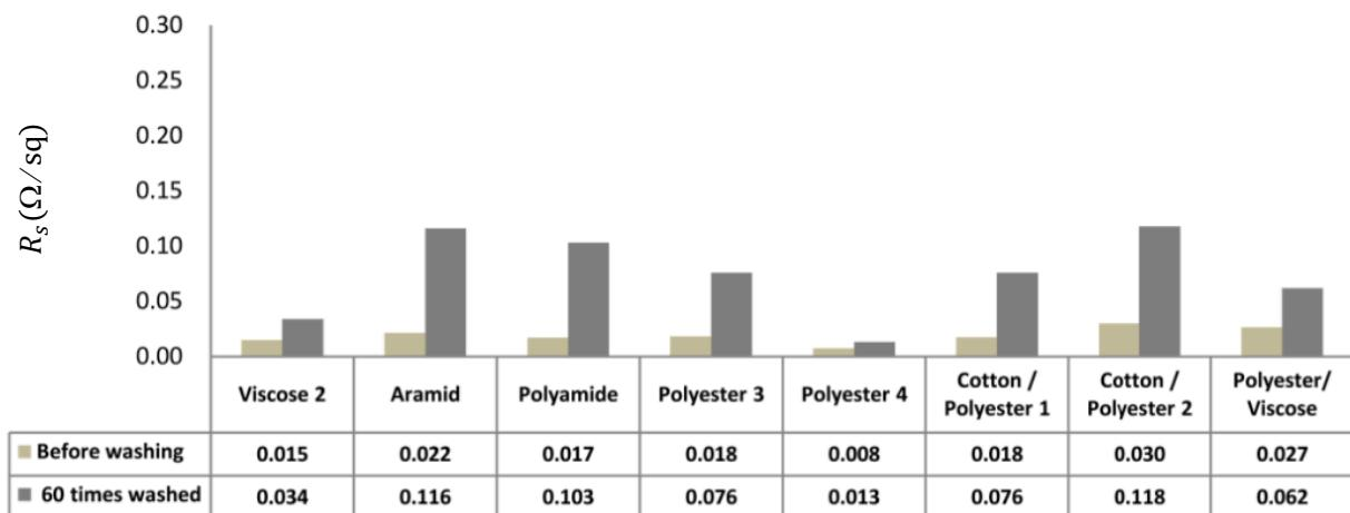
Slika 15. Otpor ispranih uzoraka prekrivenih TPU slojem otisnutih vodljivom bojom proizvođača *DuPont*
