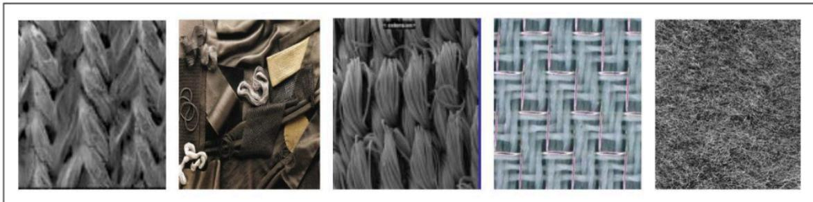
Slika 1. Vodljivi tekstil: isprepleten, premaza, istkan i filcan
