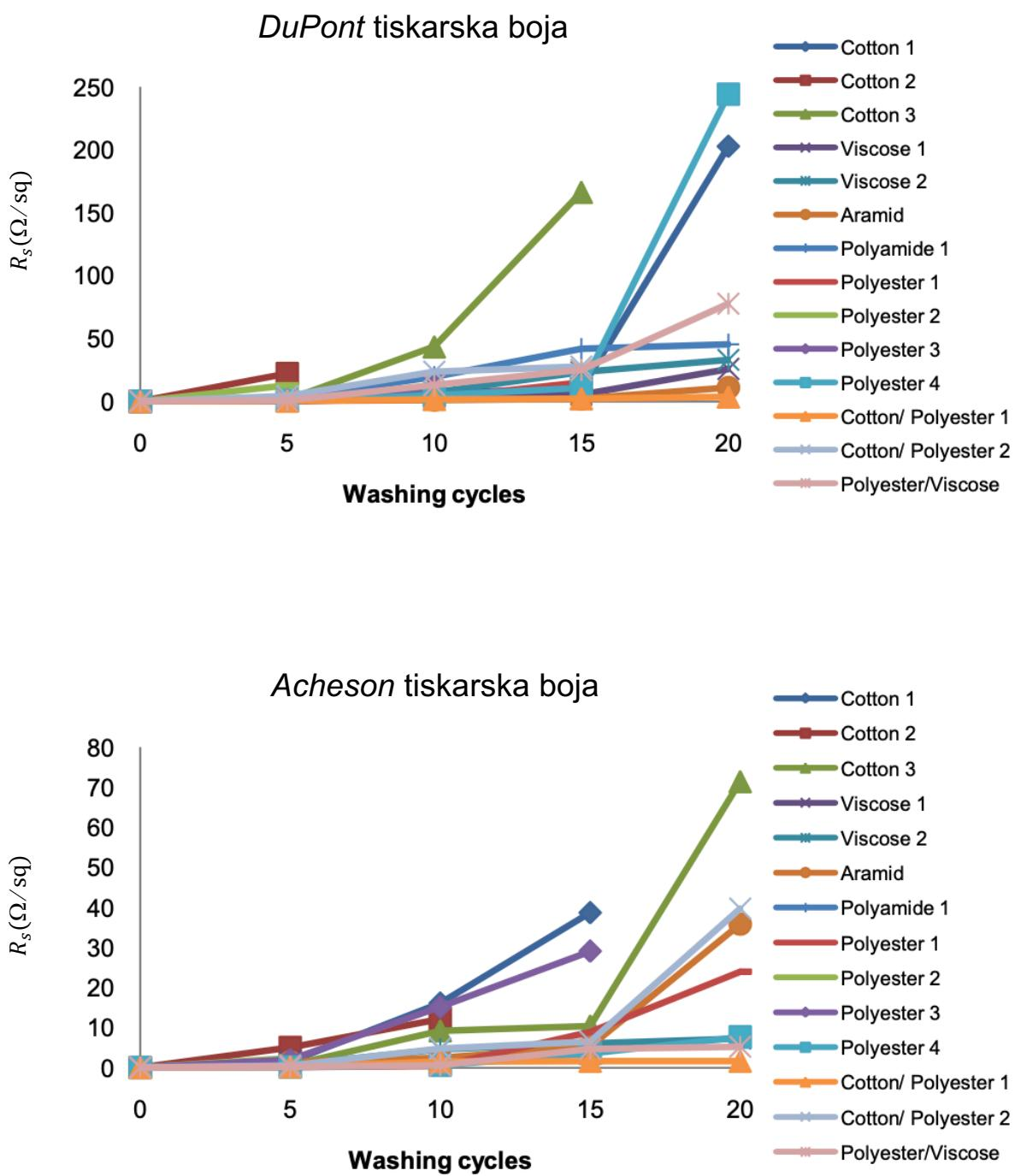
Slika 14. Otpori tiskanih uzoraka izmjereni nakon svakih pet ciklusa pranja
