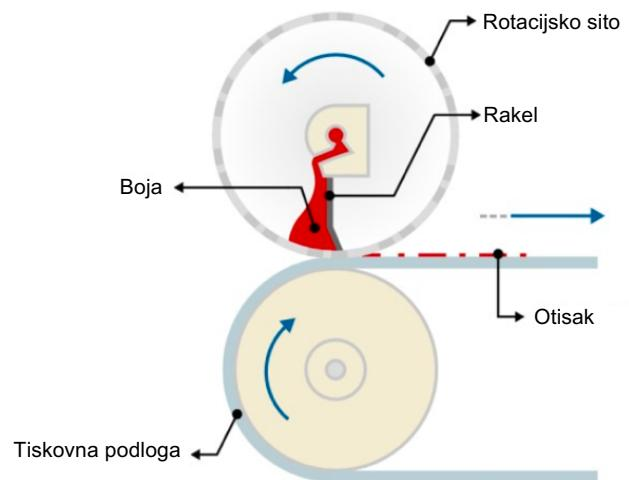
Slika 5. Konstrukcija rotacijskog sitotiska
