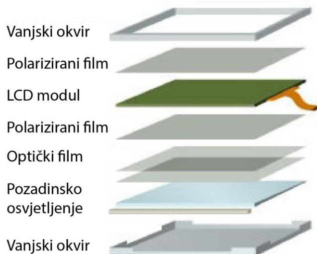
Slika 5. Dekonstruirani LCD monitor s polarizatorima
