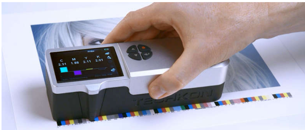
Slika 14. Prikaz postavljanja senzora uređaja na klin i vrijednosti za CMYK boje
