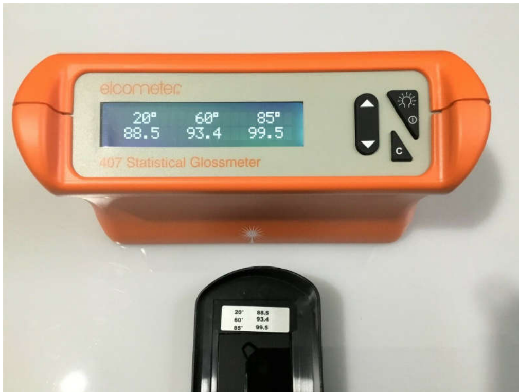
Slika 16. Prikaz mjerenja na glossmetru
