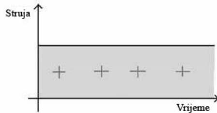
Slika 10. Shematski prikaz istosmjerne struje
