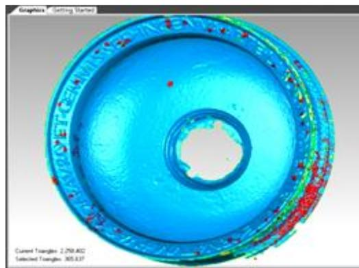
Slika 9. Zatvaranje praznih površina na 3D modelu
