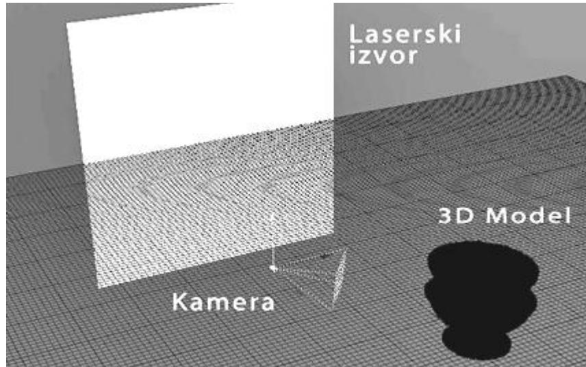
*Slika 26. Smještaj elemenata u virtualnom prostoru. Vidljiv je djelitelj snopa u pozadini kojeg je smješten virtualni laserski izvor, 3D model posude čiji se hologram izrađuje, te kamera sa virtualnim holografskim filmom*
