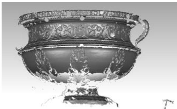
*Slika 6. Otvaranje \*.stl datoteke u Geomagic program nakon 3D skeniranja*
