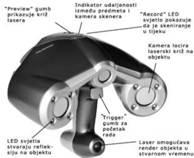
Slika 2. ZScanner 800 korišten za digitalizaciju škropionice
