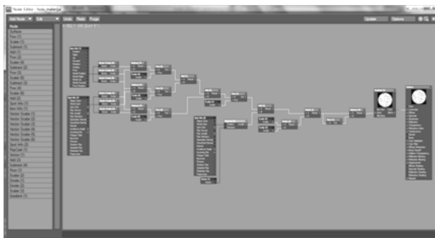
Slika 27. Redoslijed povezivanja čvorova i tok dijagrama u Node editoru kod definiranja površine materijala 3D modela, a ujedno je i ključni korak u dobivanju RGH
