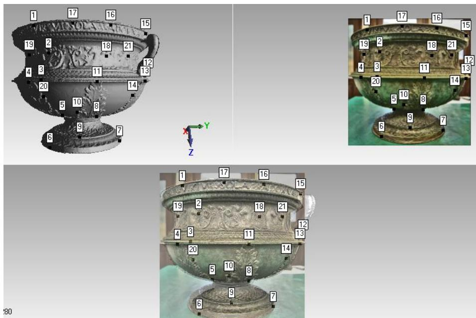
*Slika 14. Registracija fotografije sa 3D modelom. Prva slika pokazuje odabir elemenata na modelu, na drugoj slici vidljivi su ti isti elementi na fotografiji, a treća slika prikazuje rezultat spajanja modela sa fotografijom*
