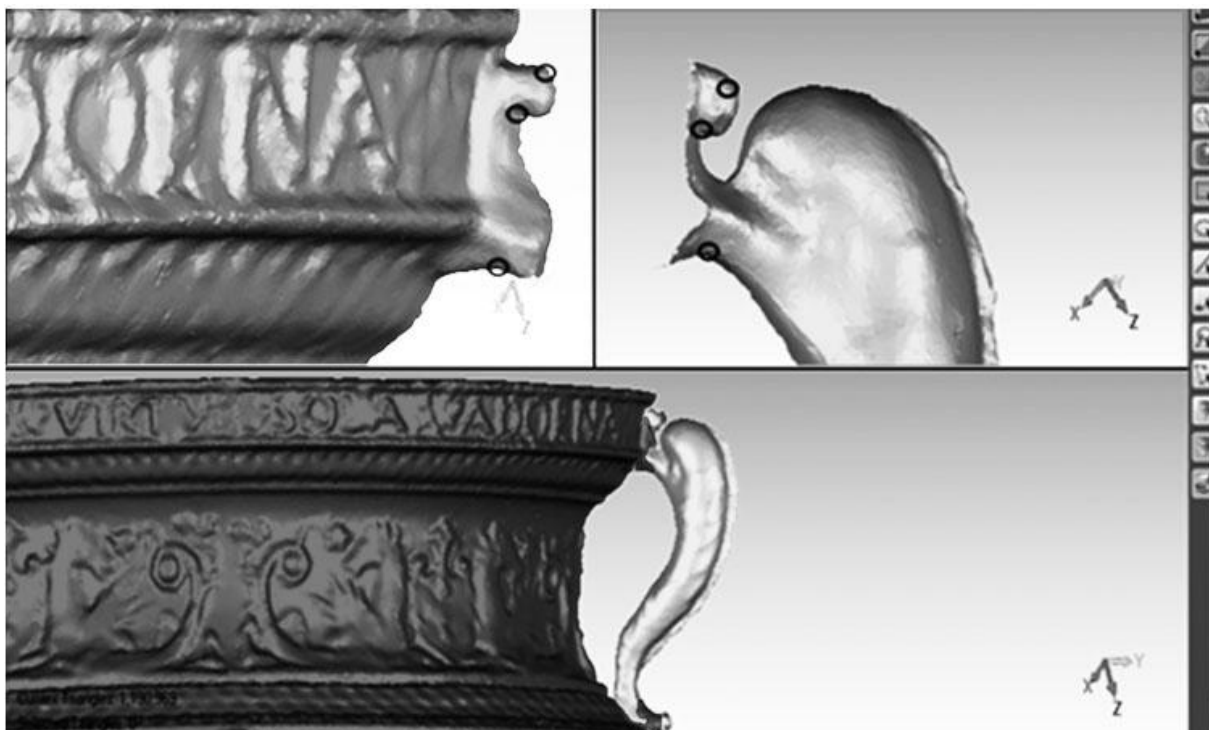
Slika 20. Ručna registracija i spajanje dijelova posude selekcijom zajedničkih točaka
