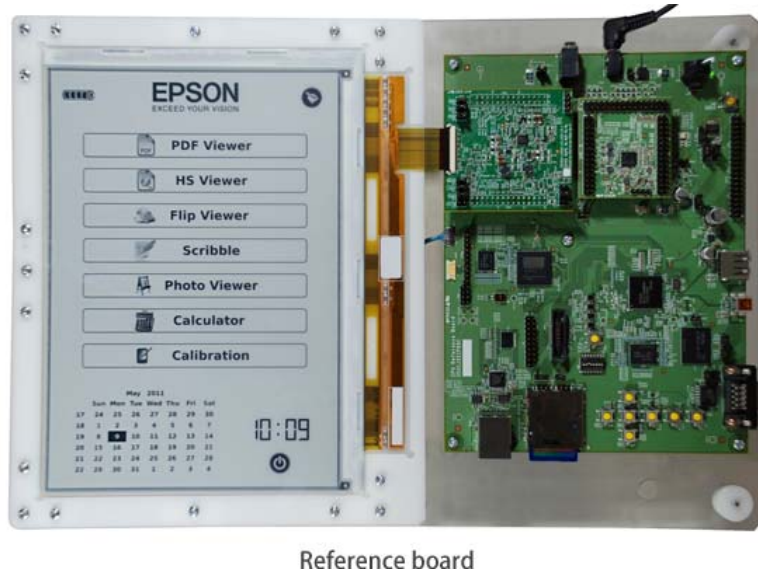
Slika 8: Unutrašnjost e-uređaja „Epson“
