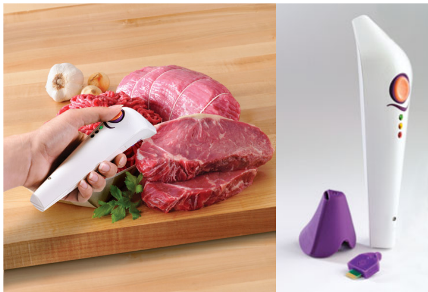
Slika 18. SensorfreshQ™ „elektronski nos“
