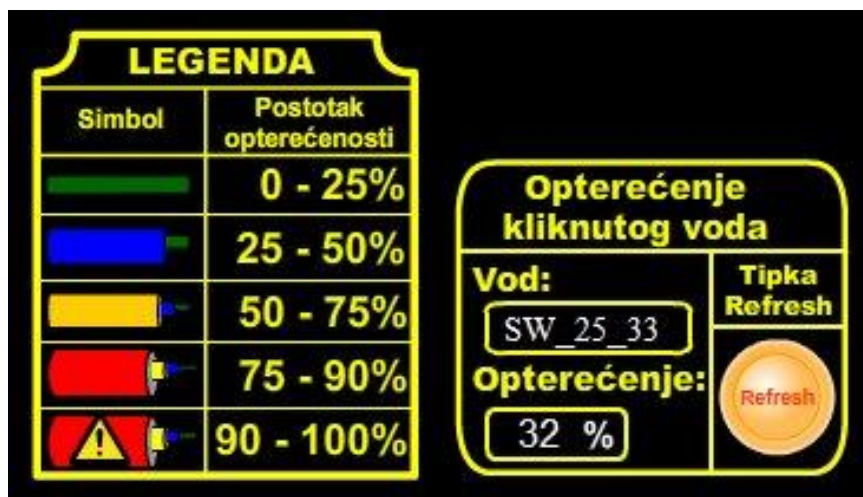
Slika 34: Grafički prikaz legende i opterećenja kliknutog optičkog voda.
