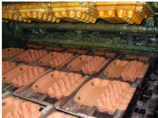
Slika 35 - Proizvodi na stroju za oblikovanje
