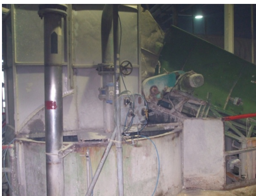
Slika 29 - Pulper iz kojeg se uzima uzorak smjese za kontrolu
