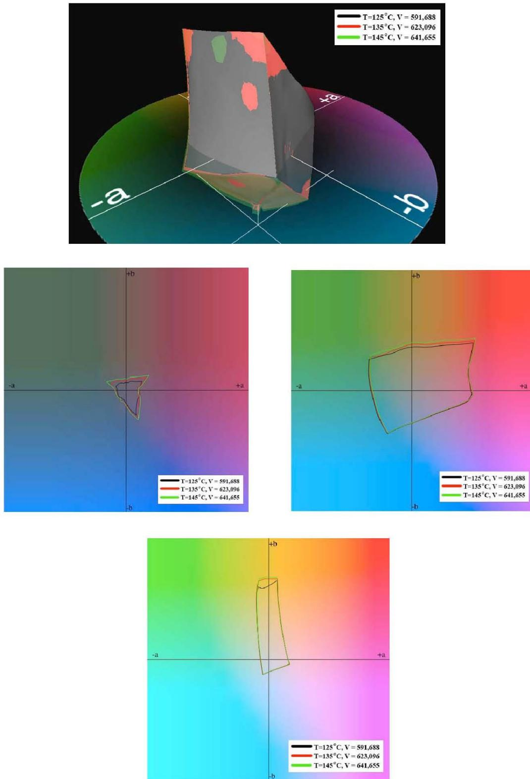
Slika 26. Usporedni dvodimenzionalni i trodimenzionalni prikaz gamuta otisaka na stroju HP Indigo TurboStream, varijacija temperature offsetnog cilindra
