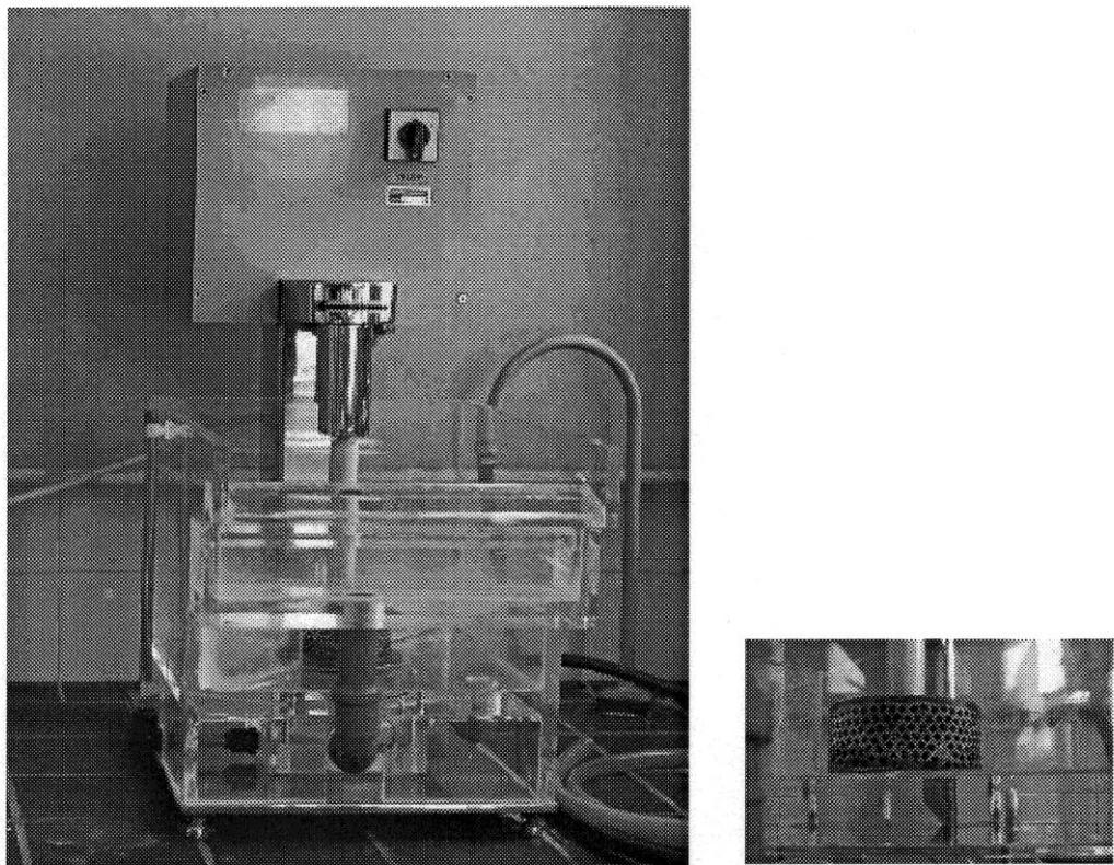
*Slika 12. Flotacijska čelija*
