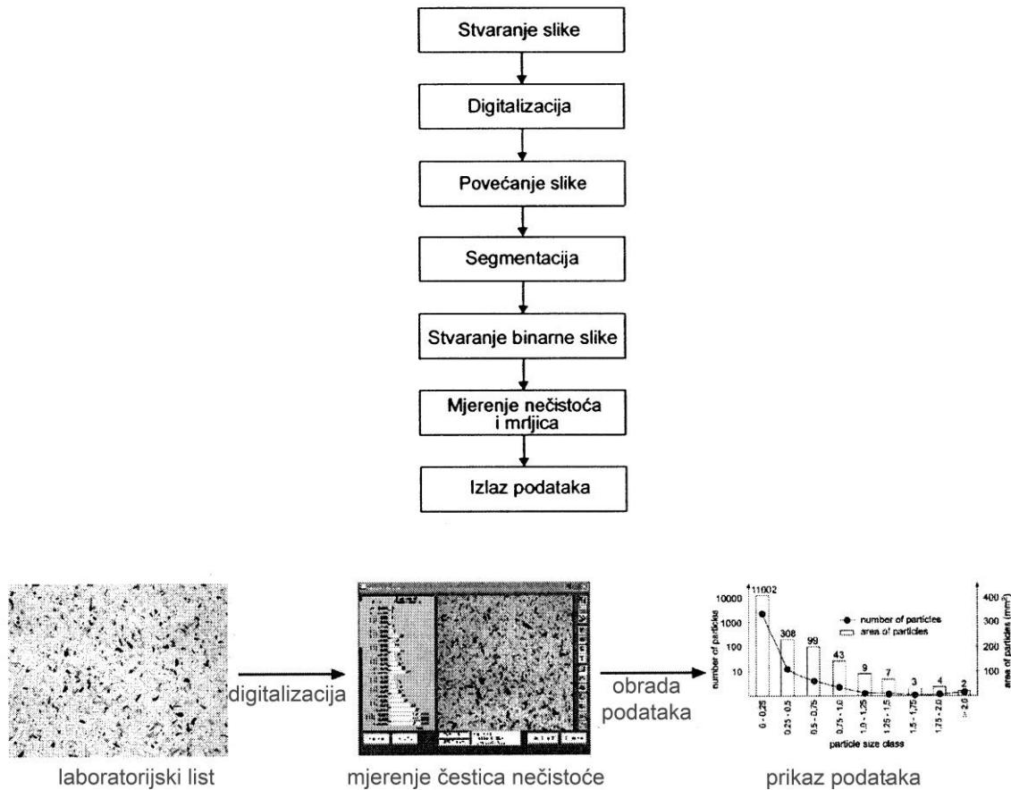
*Slika 25. Princip i tok mjerena čestica bojila i nečistoća slikovnom analizom*
