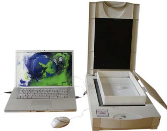
Slika 28. Slikanje na skeneru, na skener je dodana staklena kutija sa pritiskačem pomoću koje se stabilizira tekućina
