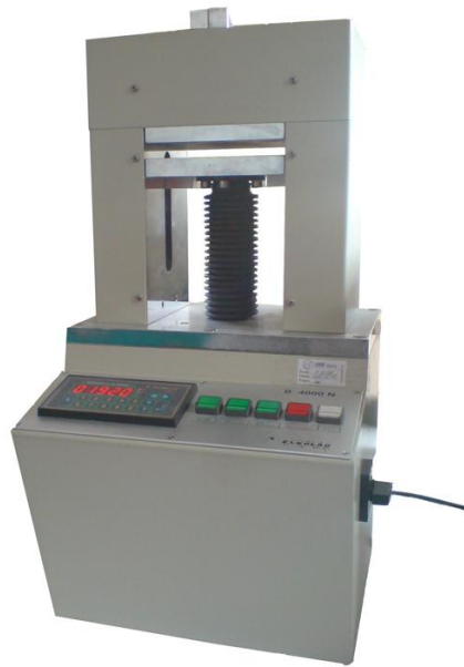
Slika 20. Višenamjenski uređaj za određivanje otpornosti valovitog kartona na tlačnu silu
