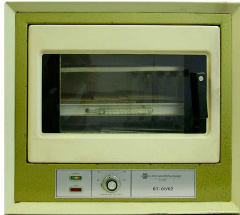
Slika 24. Sušna komora za ispitivanje sadržaja vlage valovitog kartona
