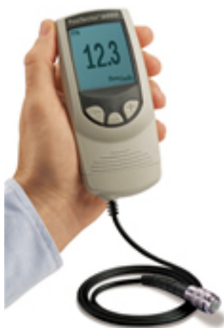
Slika 11. Uređaj za mjerenje debljine nanosa emulzijskog sloja
