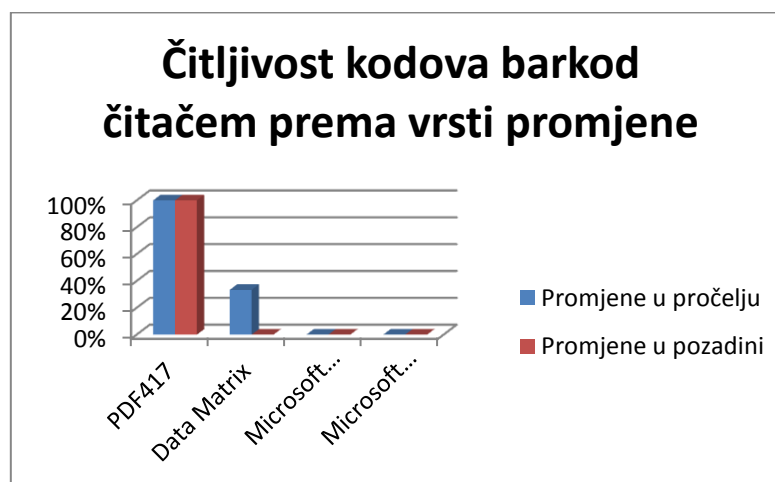
Slika 48 - čitljivost kodova putem barkod čitača obzirom na promjene
