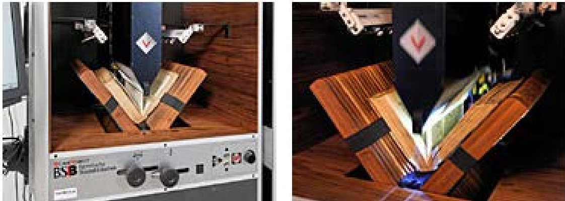
Slika 4. Robot za skeniranje knjiga tvrtke TreVentus ( http://www.goethe.de/ins/hr/zag/ - Giersberg D., Roboti za skeniranje za masovnu digitalizaciju – čak i kod osjetljivih knjiga, 11. srpanja 2013.)
