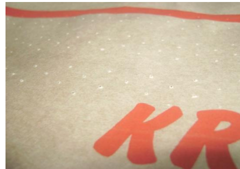
Slika 10. Izgled perforacije na ventil vreći
