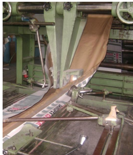
Slika 18. Sistem diskova i vodicica na Tubijeri
