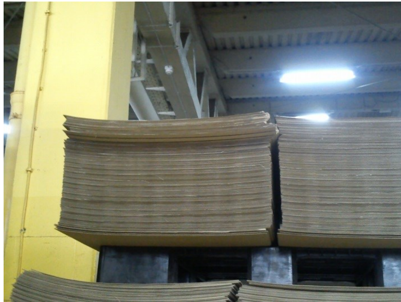
Slika 17. Gornja koritavost kod kartonskih ploča B vala
