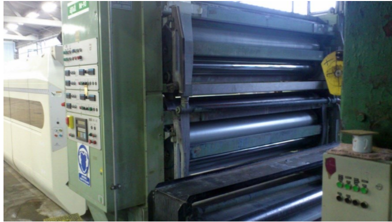
Slika 11. Drugi agregat spojen na sušaru
