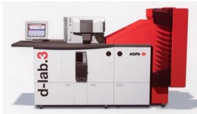
Slika 21: Agfa 3 d-lab uredaj za digitalni ispis fotografija laserskom tehnologijom
