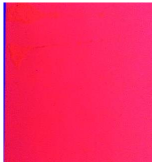
Slika 50. Ofsetni nepremazani papir s UV luminiscentnom bojom (5 g pigmenta + 50 g baze)
