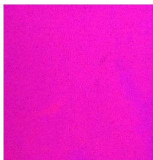
Slika 48. Ofsetni nepremazani papir s UV luminiscentnom bojom (1.5 g pigmenta + 50 g baze)
