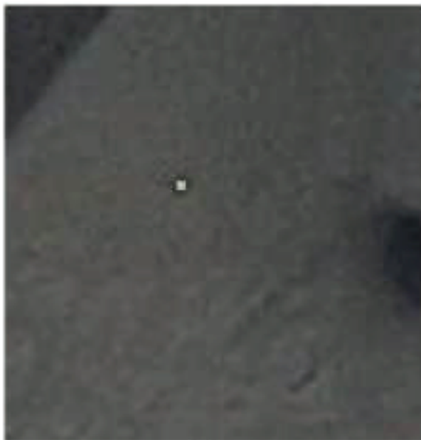
Slika 32: Primjer vrućeg piksela na nekompresiranoj fotografiji
