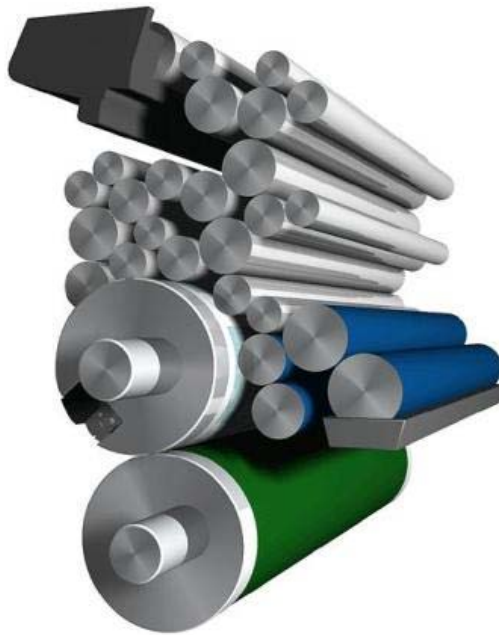
Slika 4. Shema uređaja za vlaženje (Alcolor)
