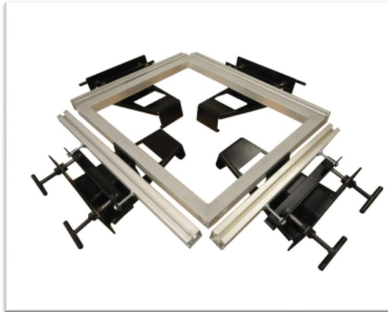
Slika 9. Stroj za ručno napinjanje sitotiskarske mreže preko okvira „Model 200“
