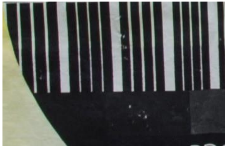
Slika 53 Oštećenja nakon pranja na 60°C - Laser - Dark
