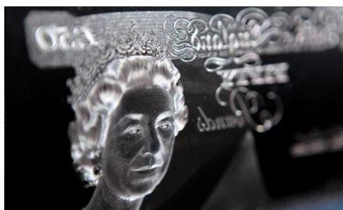
Slika 31. Tiskovna forma intaglio tehnike - britanska funta (1994.g.).
