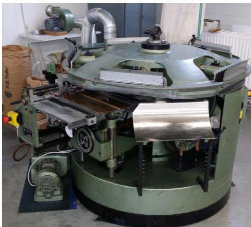
Slika 17.: Rotobinder (GRAPHA Hans Muller AG ZOFINGEN CH) [34]
