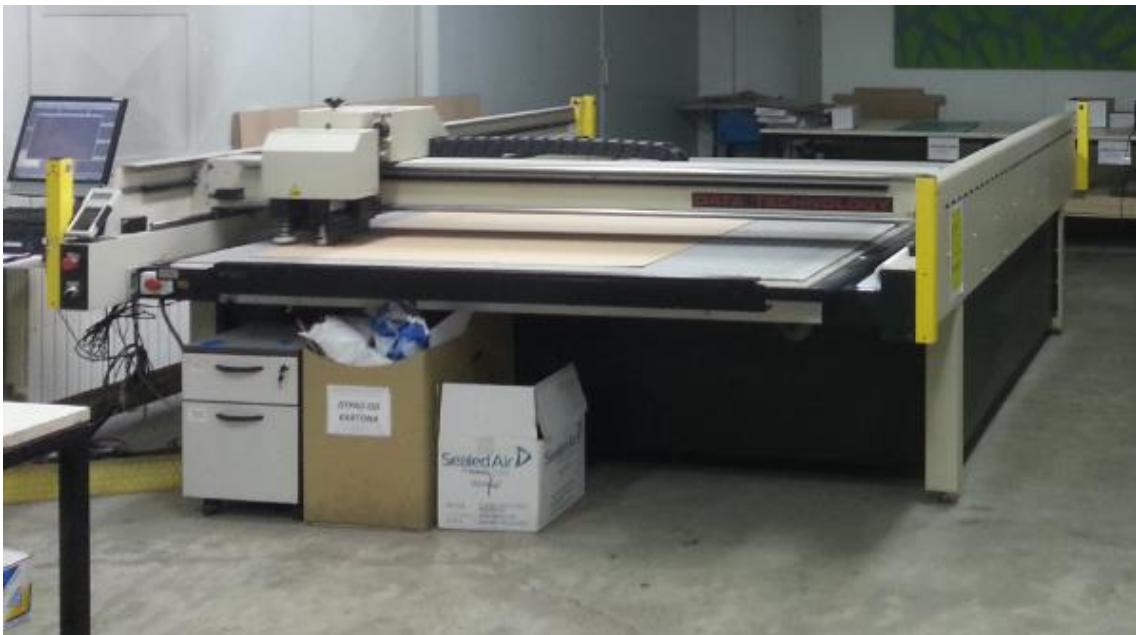
Slika 22 - Data Technology CNC rezač za valoviti karton (Model pakiranja d.d.)
