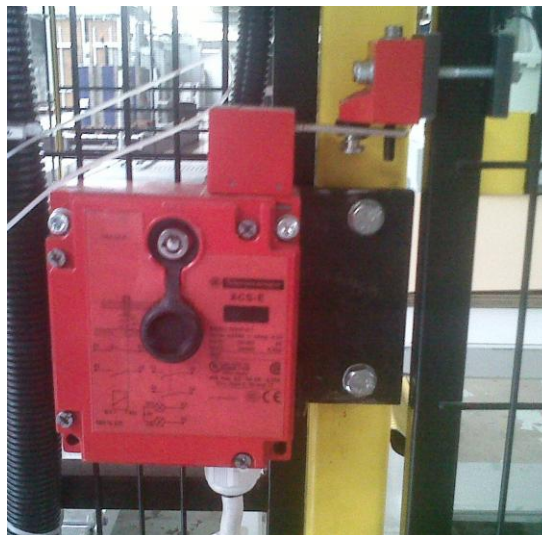
Slika 13 Vrata koje kontrolira elektromehanički granični prekidač
