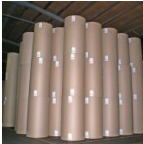
Slika 4 Papir za izradu valovitog kartona
